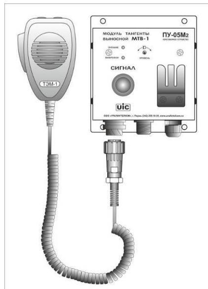
кнопку РАЗГОВОР, или передавать тональный сигнал вызова (кнопка СИГНАЛ), но если на удаленном базовом блоке включают режим «дистанционное включение микрофона выносного блока», то включится микрофон, встроенный в тангенту, подключенную к блоку МТВ-1, а в самом выносном блоке не включится (но будет включаться при нажатой кнопке РАЗГОВОР на выносном блоке).
